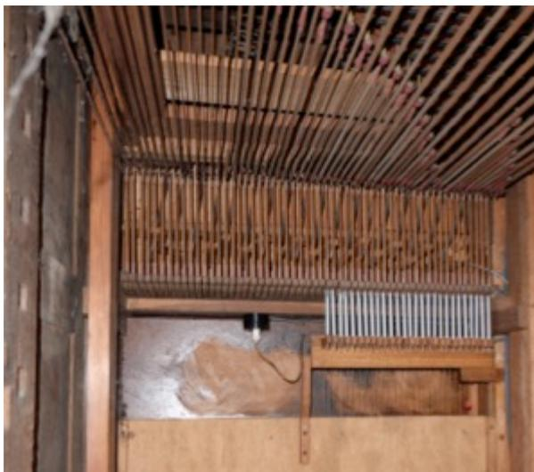
La transmission du clavier est mécanique. Le déplacement de la console a occasionné une complication de son tracé, avec adjonction d'équerres et allongement des vergettes.
