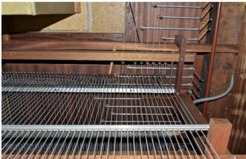
Figure 11. Détail de la mécanique des notes. Comme la console, toute la transmission est entièrement neuve. Les vergettes sont en aluminium de même que les rouleaux d'abrévés et les équerres. Les réglages se font à l'aide d'écrous en cuir.
