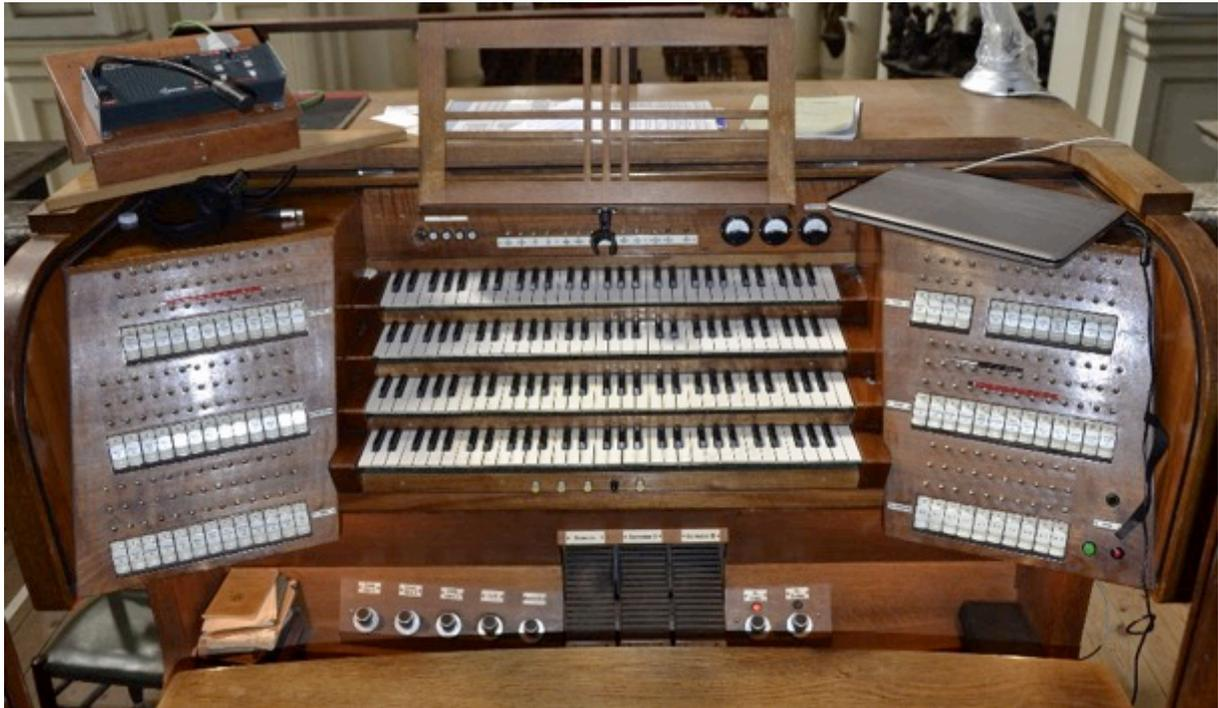
Figure 9. Console à quatre claviers manuels et pédalier ; La console actuelle a été posée à neuf lors des derniers travaux en 1963-1968. Une plaquette rectangulaire indique « Alois Thunus/Manufacture d'orgue/Malmédy ». Les quatre claviers de 61 notes sont à transmission mécanique et la registration ainsi que les accouplements sont à transmission électrique.
