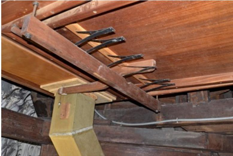
La soufflerie est alimentée par un ventilateur électrique « Meidinger », triphasé 400 v, 1400 tours/min, pression 120 mm, 2,5 HP. Celui-ci est posé dans un caisson à double paroi en « Unalit » et MDF.
