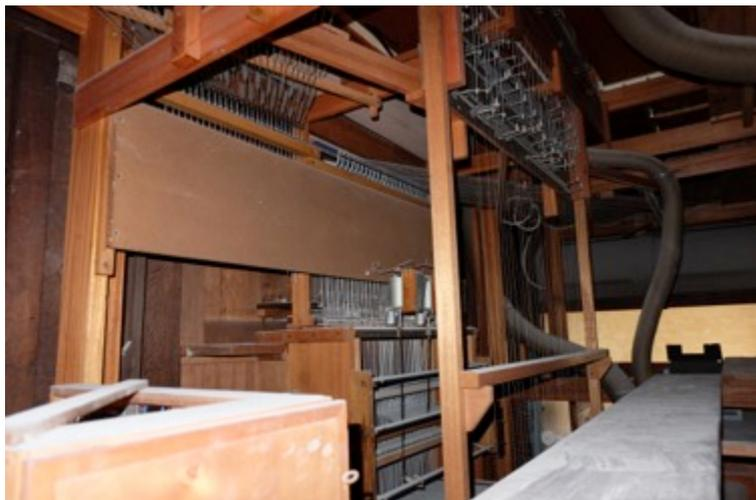
nylon traversant des bourses également en nylon. La mécanique est régulée par un système composé de ressorts, de barres de suspension et de contrepoids.
